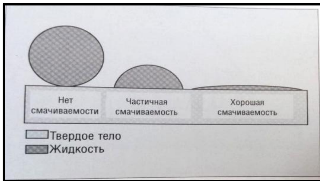
Рис.1. Характер смачивания жидкостью твердой поверхности.
